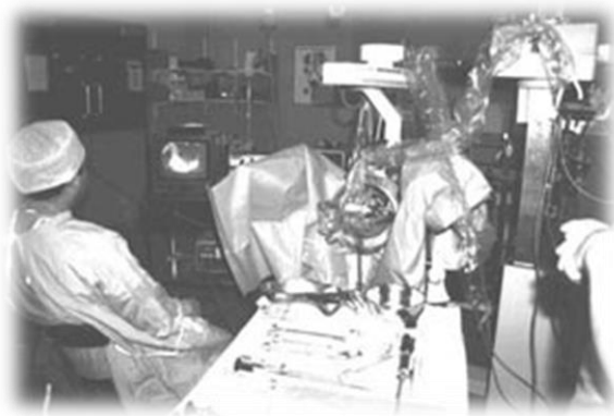
Το σύστημα PUMA 560 σε εγχείρηση διουρηθρικής προστατεκτομής. Διακρίνεται ο ξαπλωμένος ασθενής με τα πόδια ανοιχτά, ανάμεσα στα οποία στερεώθηκε το ρομποτικό σύστημα, ενώ ο χειρουργός παρακολουθεί την επέμβαση.
